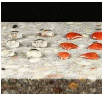
Pav. 1 paviršius, apdorotas impregnantu Mapecrete Stain Protection
